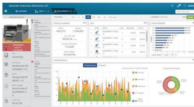
Opcenter Connect Electronics genera cruscotti basati sulle prestazioni che mostrano informazioni per macchina, linea o livello di fabbrica, incluso il riepilogo del periodo, la quantità di errori della pick-and-place e informazioni generali sulle macchine.
