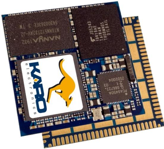
**Bildunterschrift:** Die Computer-on-Modules der einlötbaren QS-Produktfamilie besitzen auf ihrer Unterseite nur metallische Flächen und konnten mithilfe von Simulations-Software effizient entwickelt werden.
